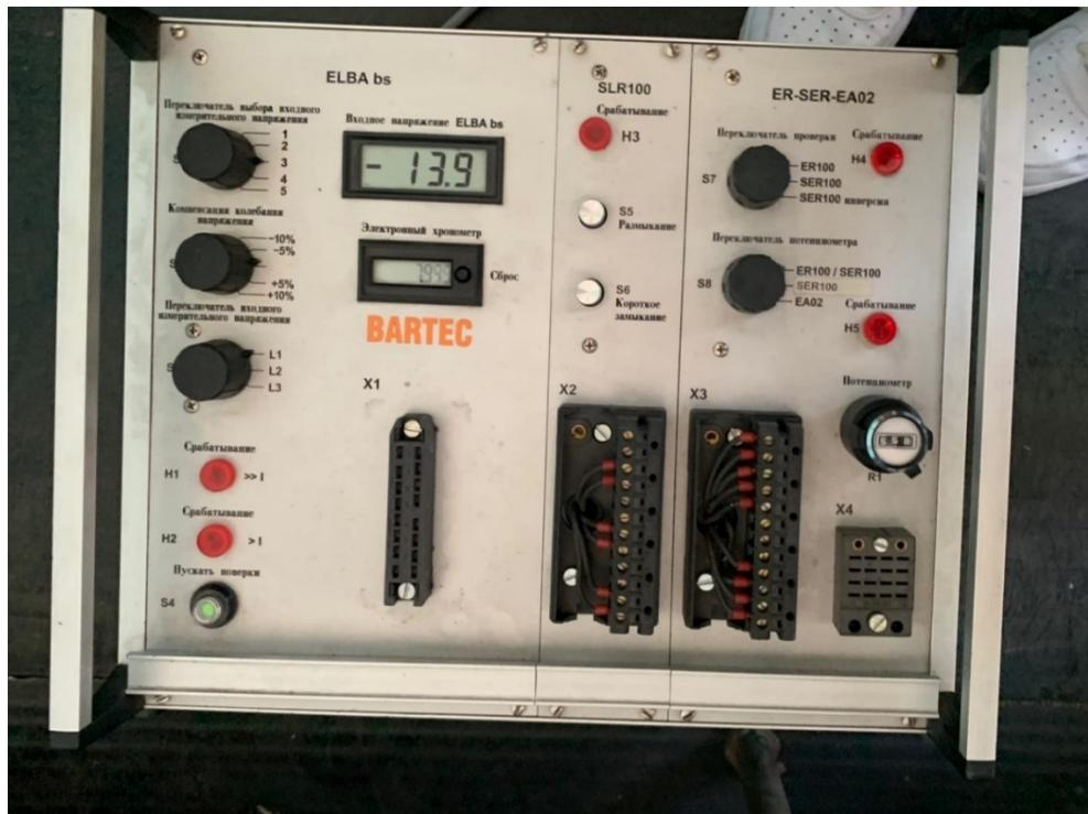
Рисунок 5 - Универсальный диагностический прибор UP-102
